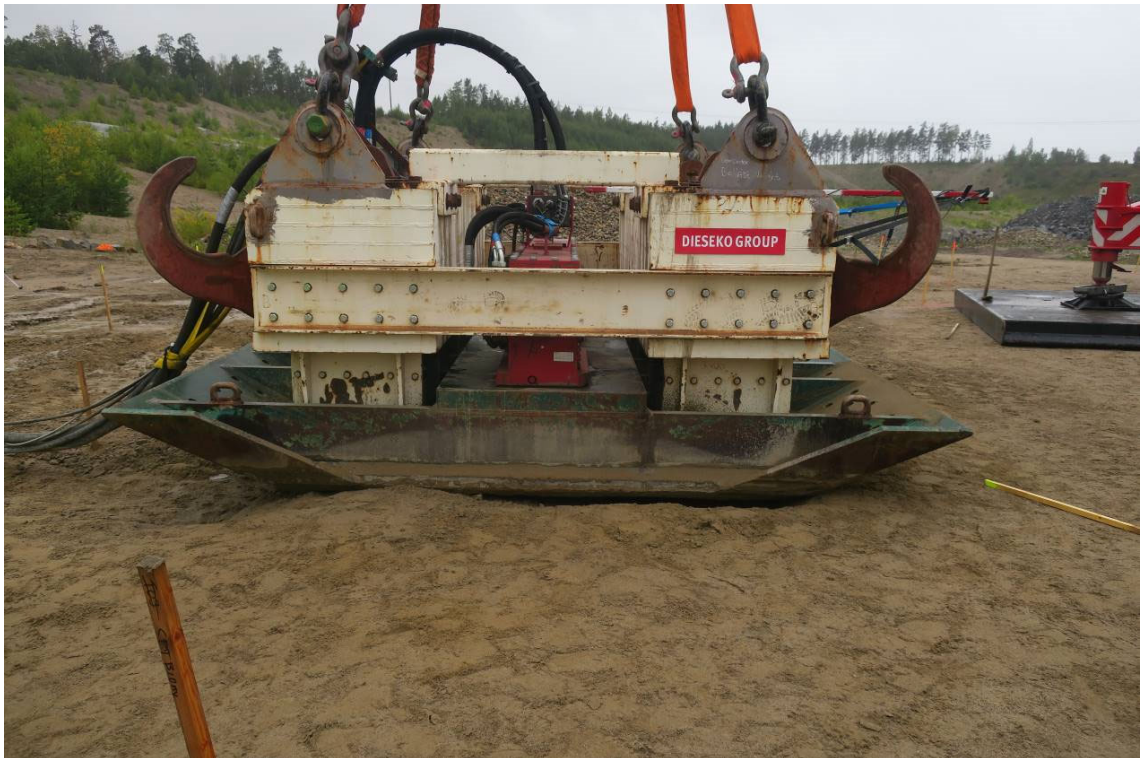
Figur 19. Packningsutrustning bestående av platta (grön), vibrationshammare (röd) och upphängningsmassor (vit).
