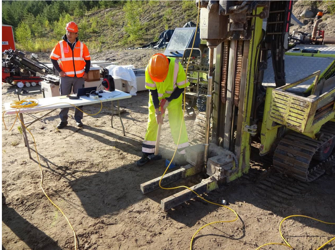
Figur 5. Nerhålsförsök (seismisk dilatometer).
